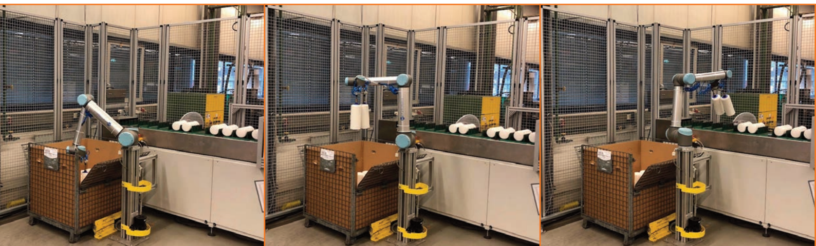
Bild 1 | Ein Roboter nimmt einen Filter aus der Gitterbox und legt ihn positionsgenau auf dem Band ab. Die Programmierung des Roboters sowie die Verbindung zu dessen Komponenten (Vision-Sensor,...) erfolgt in der Programmierumgebung Artiminds RPS.
