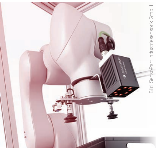
Bild 3 | Je nach Anwendung lässt sich der Vision-Sensor auch direkt am Roboterarm befestigen.
