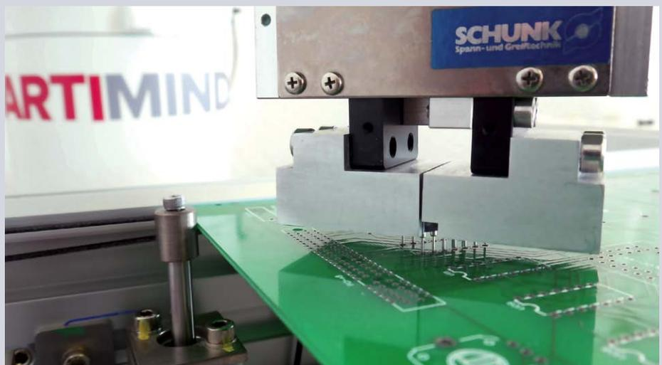
Mit dieser Art der Programmierung werden nun neue Anwendungen wie etwa die Durchsteckmontage (Through Hole Technology, THT) realistisch umsetzbar.
