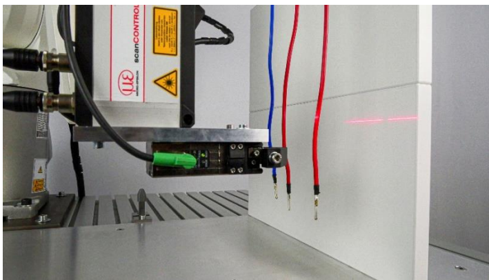
Bild 2: Freihängende Kabel, die sich in alle Richtungen verwinden können, lassen sich mittels Laserscanner treffsicher detektieren und picken; Quelle: ArtiMinds Robotics GmbH
