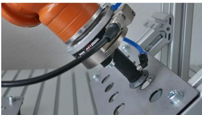
Bild 3: Ziel des Forschungsprojektes ist es, die Effizienz und Flexibilität von anspruchsvollen Produktionsprozessen, wie die kraftsensitive Montage mit Robotern, zu steigern; Quelle: ArtiMinds Robotics GmbH
