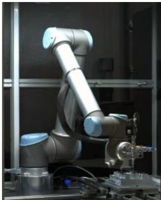
Durch die Möglichkeit, CAD-Daten für die Bahngenerierung und sensorische Komponenten einzubinden, lassen sich die Roboterprogramme schnell und kosteneffizient an unterschiedliche Bauteilgeometrien anpassen.
