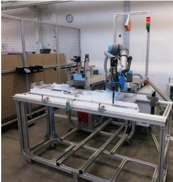
**Bild 1:** Ein Leichtbauroboter, ergänzt um ein spezielles Schraubsystem, übernimmt die Montage der Linearführung der Patientenliegen. Die Robot Programming Suite und der ArTIA-Connector sorgen für eine Kopplung von Roboter und SPS; Quelle: Siemens Healthineers
