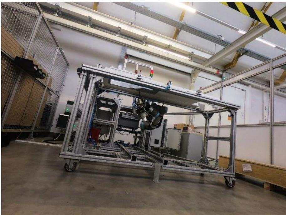
**Bild 2:** Die 280 Schraubprozesse pro Liege mussten teilweise über Kopf und gebückt verrichtet werden. Der Roboter übernimmt diese unergonomische Arbeit nun ohne Probleme; Quelle: Siemens Healthineers
