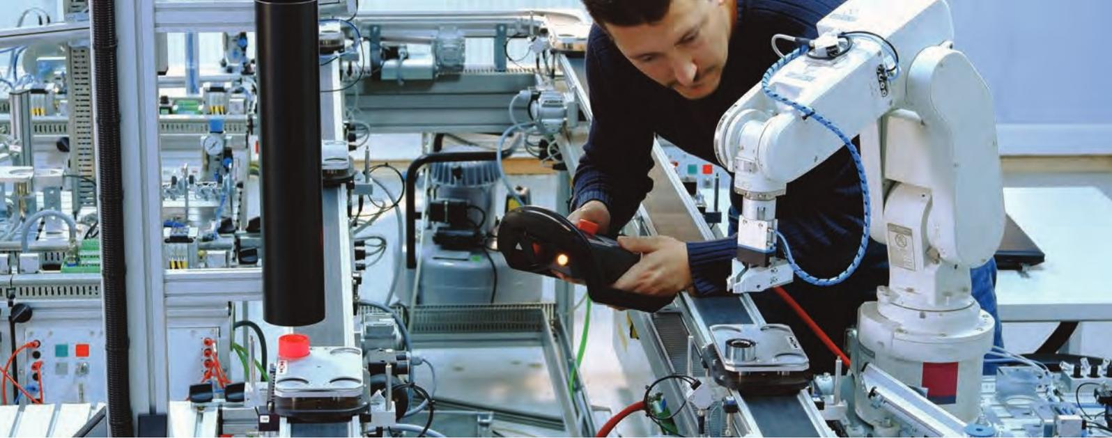
Bei der Instandhaltung von Roboteranlagen werden üblicherweise einzelne Teach-Punkte, das heißt zentrale Wegpunkte des Roboters, korrigiert oder Teile des Roboterprogramms neu vermessen.
