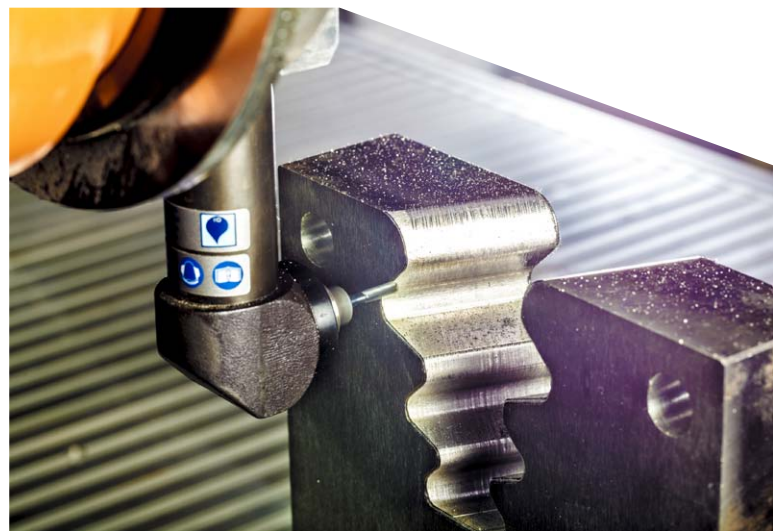
Beim Entgraten von Schnittkanten erschweren die hohen Prozessanforderungen hinsichtlich Präzision und gleichbleibender Qualität eine automatisierte Verarbeitung. Bild: Fraunhofer IPA/Rainer Bez
