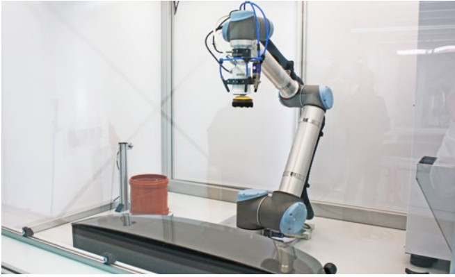
Die Bauteile werden über ein Drehtisch in die Roboterzelle befördert, links ist die Pad- Reinigunngsvorrichtung zu sehen, rechts der Pad-Spender.
